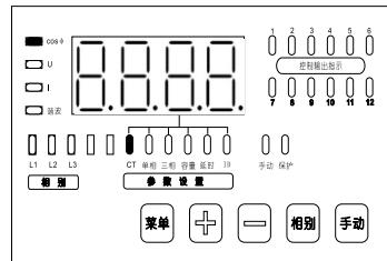
此项显示进线电流互感器变比的比率值。短按**+/-**键，步进修改量值，长按**+/-**键，数字将快速变化。按**菜单**键进入下一项参数设置。以下操作类似。
